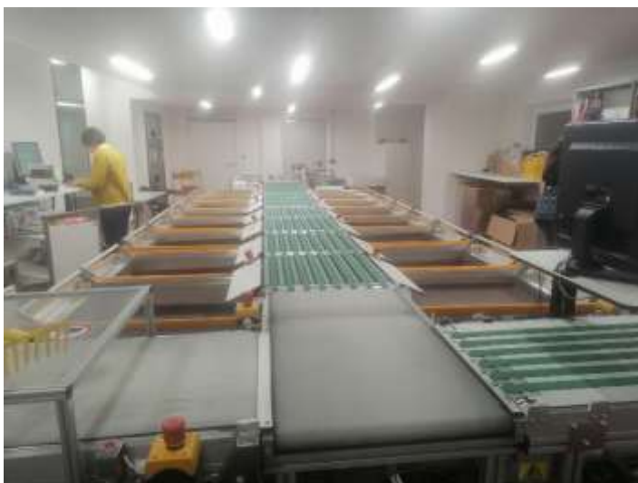
„Ruckgabeautomat” – aici vin cărțile restituite de cititori la automat. Sunt presortate pe domenii, fiecare container cu grupa specifică. De aici sunt luate și duse la raft.
